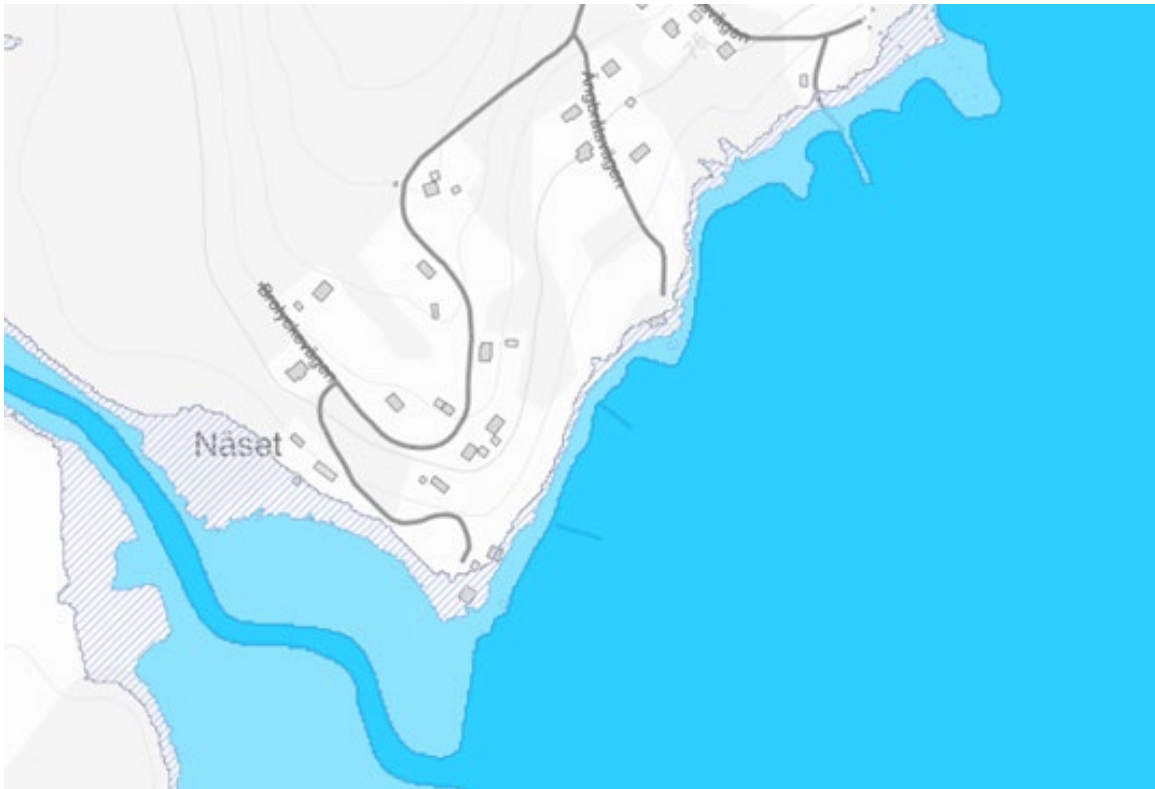
Figur 4: MSBs översvämningskartering med berörda fastigheter närmast vattnet. 100 års nivån illustreras av den mörkaste blå färgen, ljusblå yta visar 200 års nivån och skrafferad yta visar beräknat högsta flöde (BHF).
